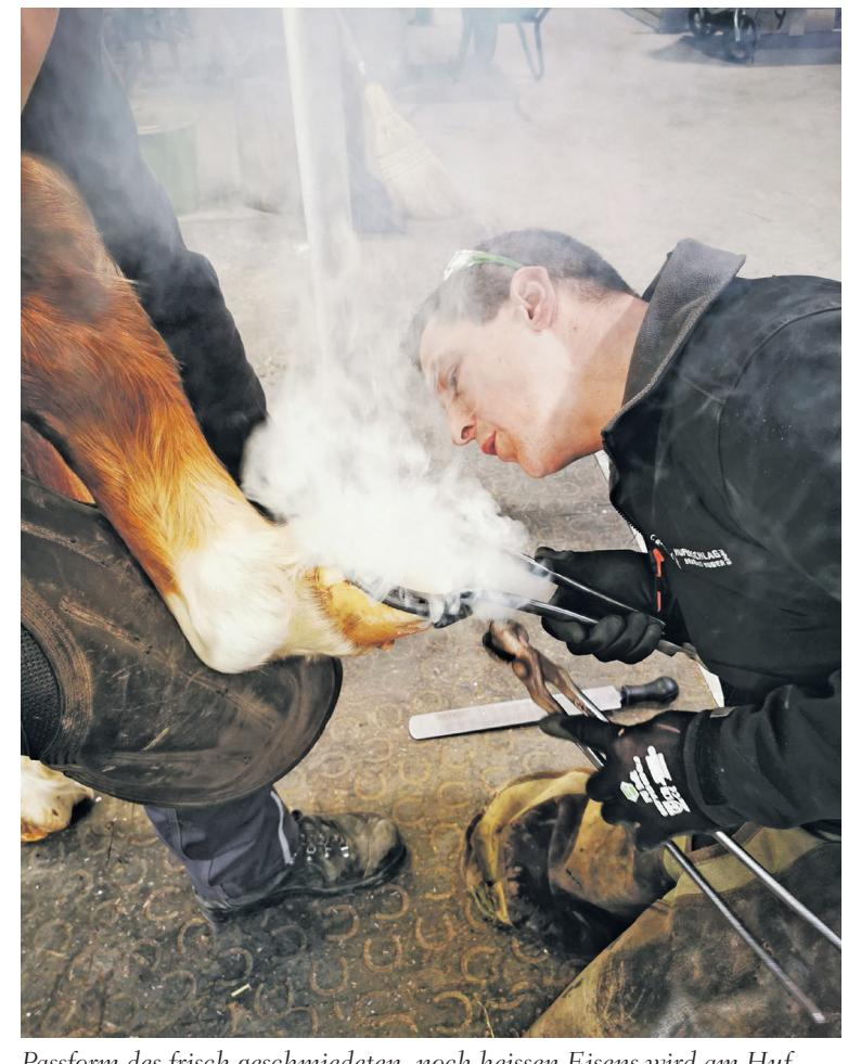
Passform des frisch geschmiedeten, noch heißen Eisens wird am Huf überprüft.
