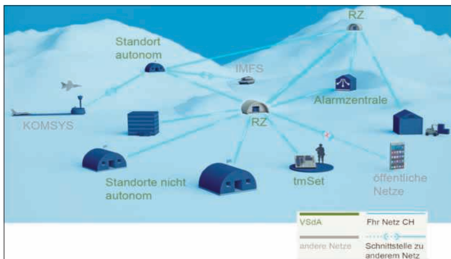
Doppelt aufgebaute Infrastrukturen sind das Herz des Systems. Die Kommunikation der verschiedenen Standorte basiert auf dem Führungsnetz Schweiz.
