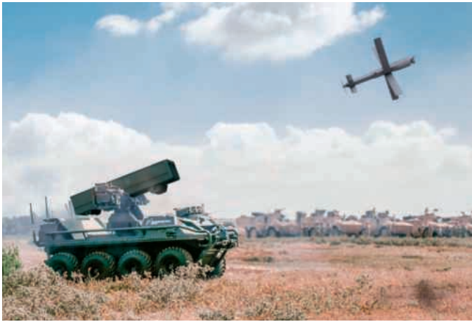
HERO-120 Loitering Munition: Diese Kamikaze-Drohne, von denen vier Stück mitgeführt werden, kann sowohl als Sensor als auch als Effektor eingesetzt werden.
